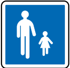
B54 Entrée d'Aire piétonne.
